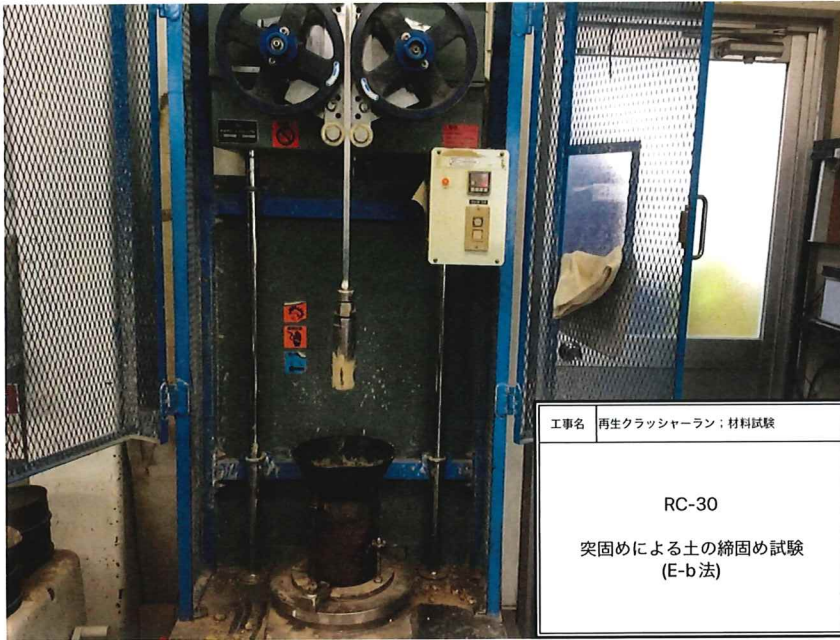
工事名 再生クラッシャーラン；材料試験 RC-30 修正 CBR 試験 (供試体作製状況)
