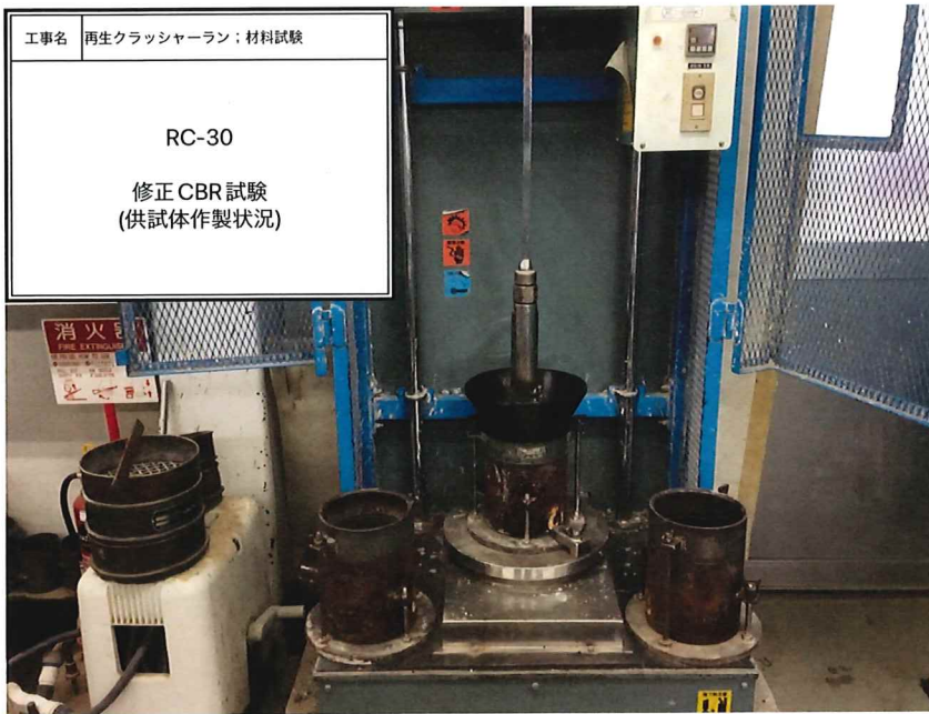
工事名 再生クラッシャーラン；材料試験 RC-30 突固めによる土の締固め試験 (E-b法)
